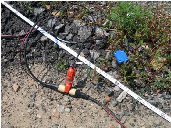
I sensori disposti sul terreno sono geofoni (Mark Products) caratterizzati da una frequenza di smorzamento di 14 Hz. Vengono adottate semplici geometrie di acquisizione, esse prevedono l'allineamento di n. 24 geofoni con spaziatura costante pari a 2 metri.
