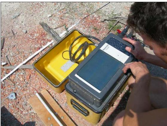
Per l'acquisizione sismica si utilizza un sismografo a 24 canali, dotato di un convertitore analogico-digitale a 16 bit (15+1) e di un amplificatore analogico digitale (24 dB) che determinano un dynamic range (120 dB), in grado di riprodurre in modo molto accurato il segnale sismico.
